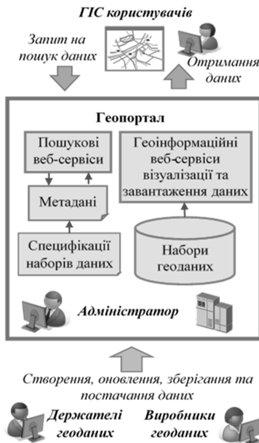
Рис. 2. Схема базової архітектури НІГД
